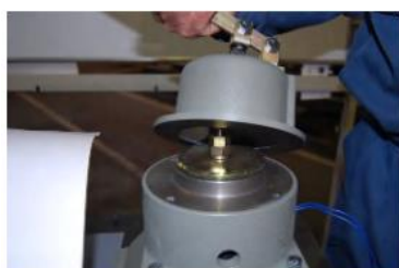
写真5 : カバー取り外し
